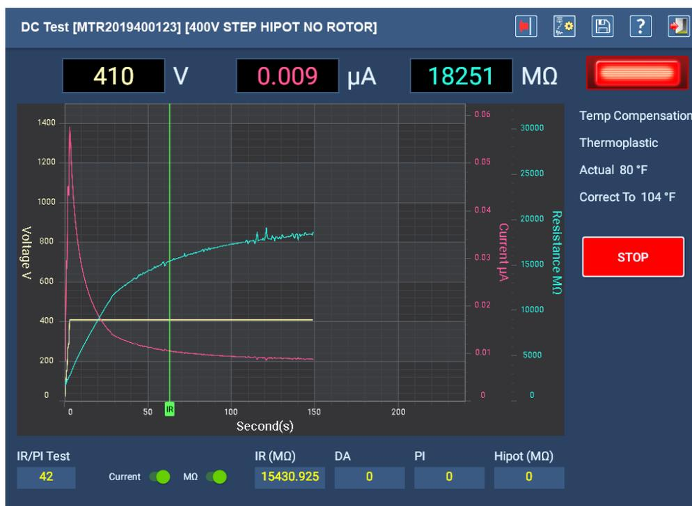
Fig. 58: Pantalla de medición de CC automática.
