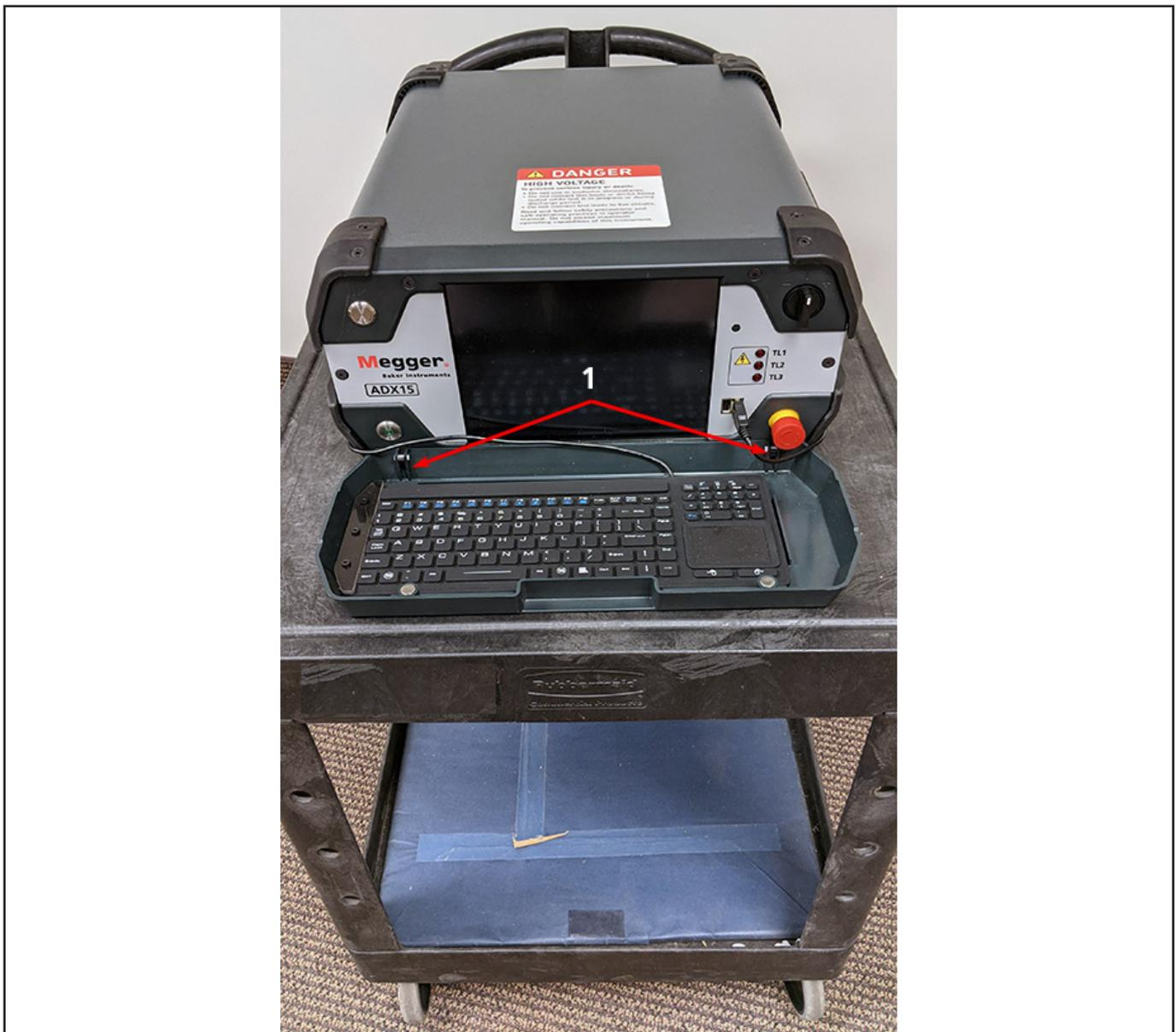
**Fig. 30:** ADX sobre el carro de trabajo; todos los topes inferiores hacen contacto total; ruedas bloqueadas.
