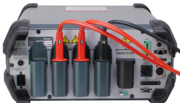
Fig. 3: Inspeccione los receptáculos y los hilos de los cables de prueba antes de cada uso.
