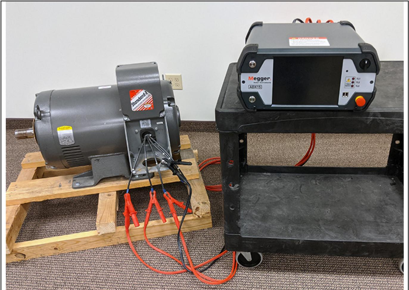
**Fig. 35:** Asegúrese de que los cables de medida del ADX y los cables del activo estén correctamente separados y ubicados.
