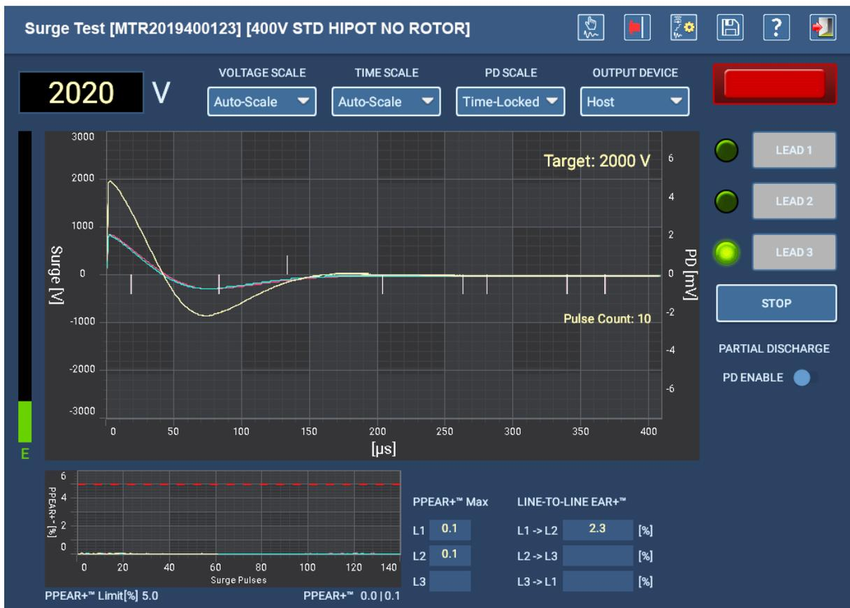
Fig. 65: Pantalla de medida de onda de choque automática.
